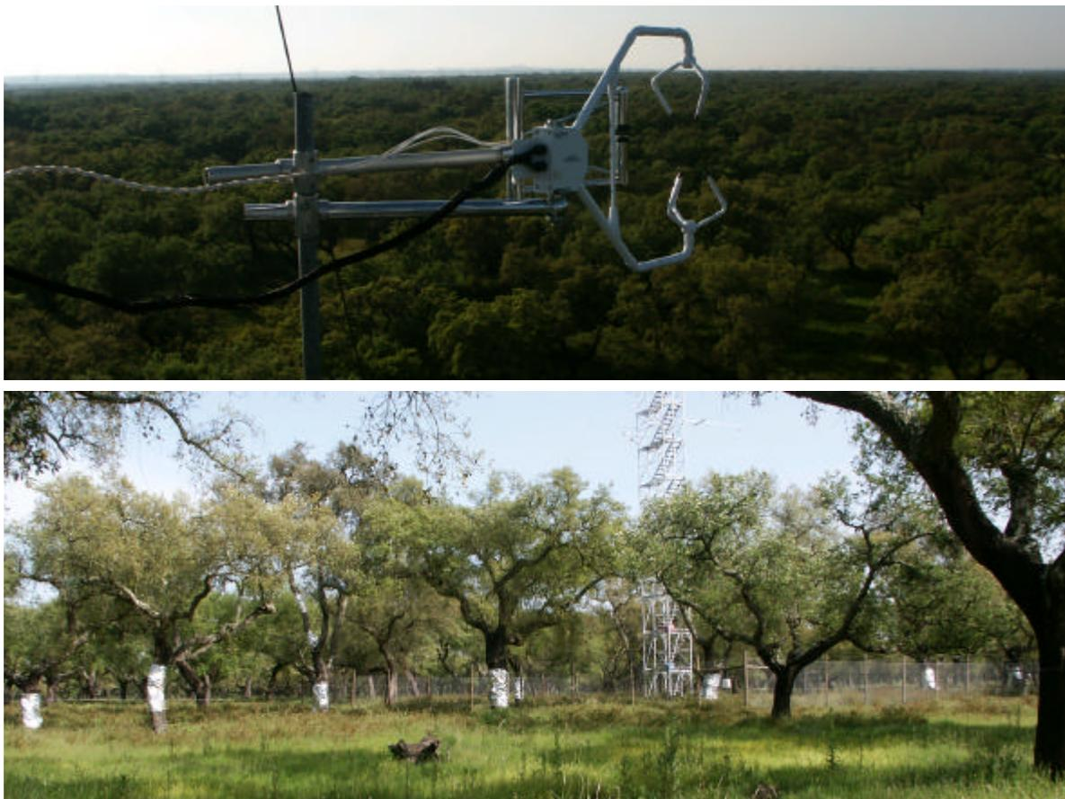
Figura 2 – Medição de ET e de Tr: (a) aspecto geral acima do coberto, anemómetro sónico 3 D e higrómetro de cripton, (b) alguns dos sobreiros equipados com sensores de medição de fluxo de seiva e torre de observações meteorológicas e micrometeorológicas (Rio Frio, Palmela, 2003).
