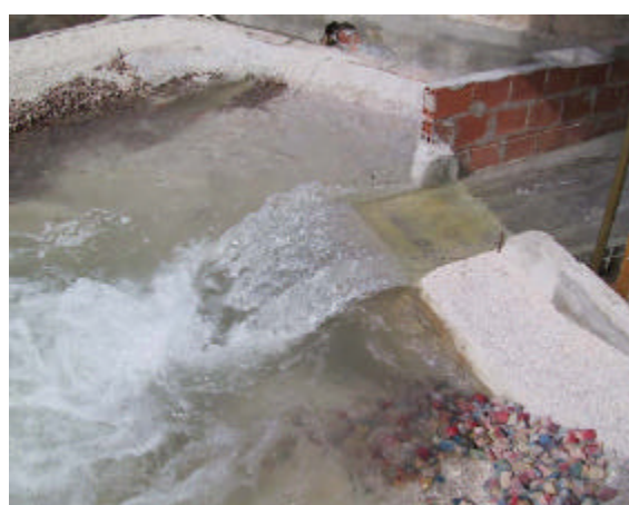
Funcionamento dado salto de ski do descarregador
