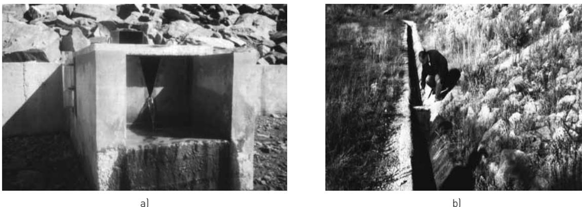
Figura 4 – Medidores de caudal: a) atravessado por um tubo; b) calibrado
