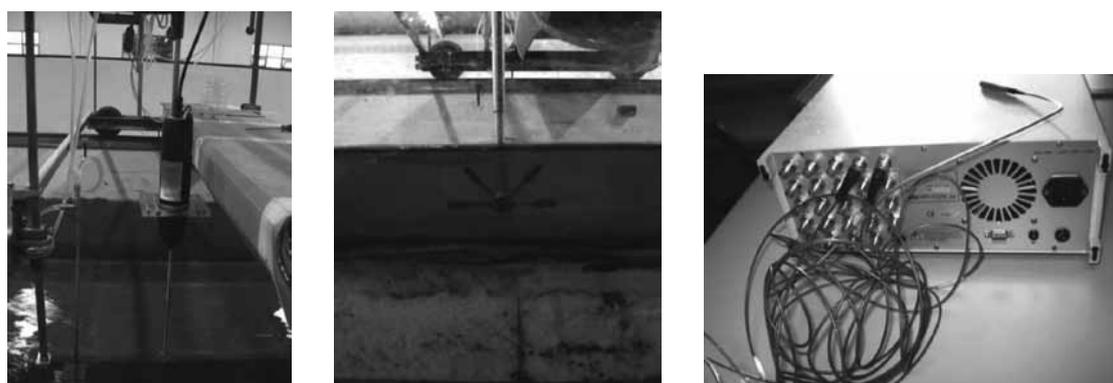
Figura 5 – Sensores para medição de velocidades: Esq. – vectrino; Dir. – UVP
