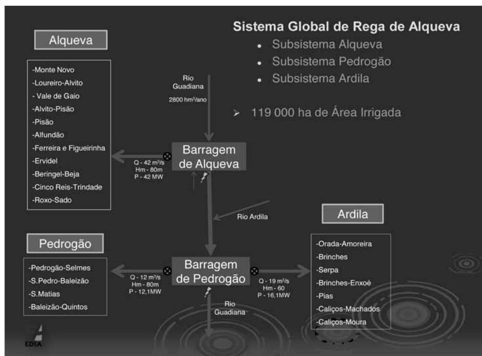
Figura 9 – Diagrama dos 3 subsistemas do EFMA.
