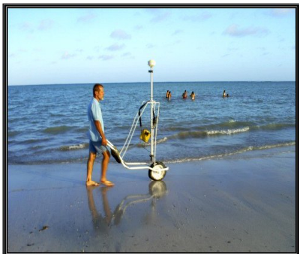
Figura 4. Foto do protótipo de um veículo apropriado para transporte da antena do GPS.
