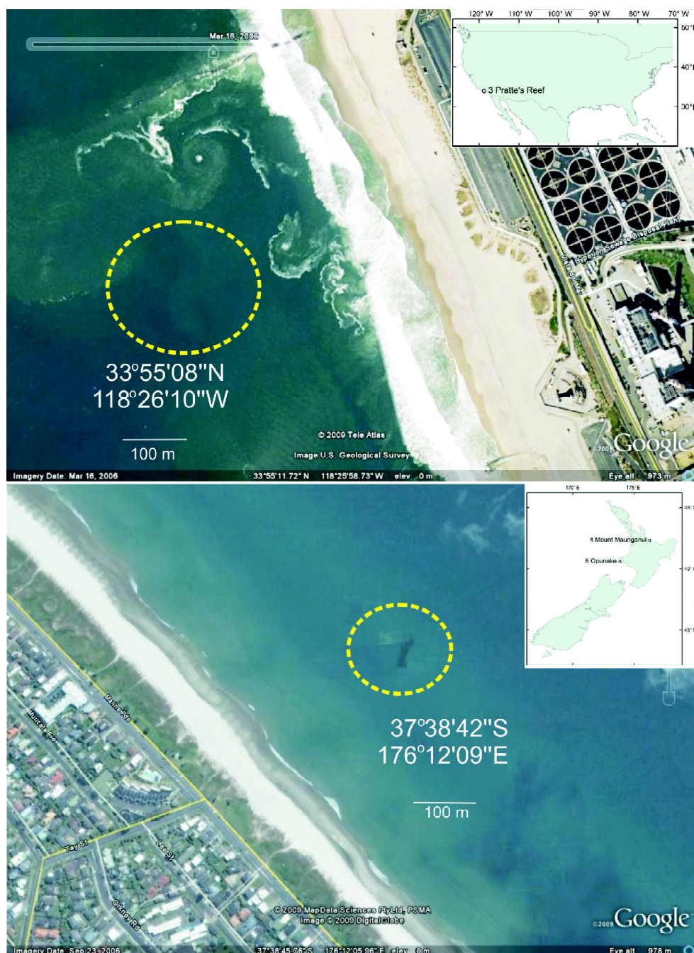
Figura 2. Localização dos RAM construídos em El Segundo, Califórnia, Estados Unidos (acima) e em Mount Maunganui, Nova Zelândia (abaixo). Os círculos amarelos indicam a posição do recife. O mapa da Nova Zelândia também indica a localização do recife em construção em Opunake.
