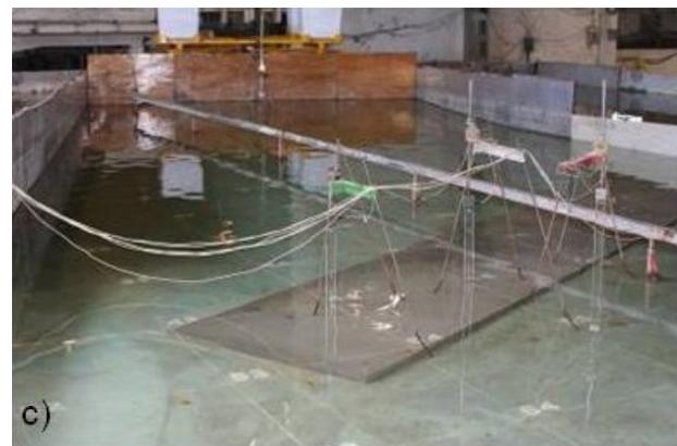
Figura 2. a) Batimetria da área em estudo; b) Modelo físico sem o recife; c) Modelo físico com o recife.
