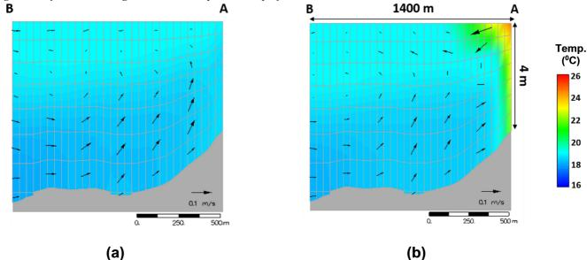
Figure 8 - Results for temperature profile, without (a) and with (b) discharge, in north wind scenario. Figura 8 - Resultados para o perfil de temperaturas, sem (a) e com descarga (b), no cenário de vento norte.
