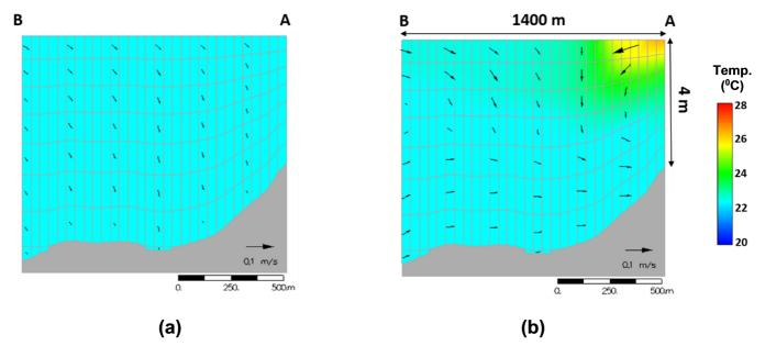
Figure 9 - Model for temperature profile, without (a) and with (b) discharge, in south wind scenario simulations. *Figura 9 - Resultados para o perfil de temperaturas, sem (a) e com descarga (b), no cenário de vento sul.*
