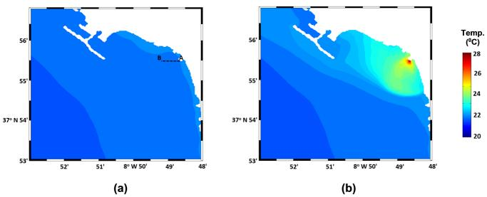
Figure 5 - Model results for surface temperature, without (a) and with (b) discharge, in south wind scenario. *Figura 5 - Resultados para a temperatura à superfície, sem (a) e com descarga (b), no cenário de vento sul.*
