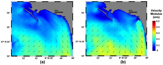
Figure 2 - Model results for the velocity modulus, without (a) and with (b) discharge, in north wind scenario. *Figura 2 - Resultados para o módulo da velocidade, sem (a) e com descarga (b), no cenário de vento norte.*
