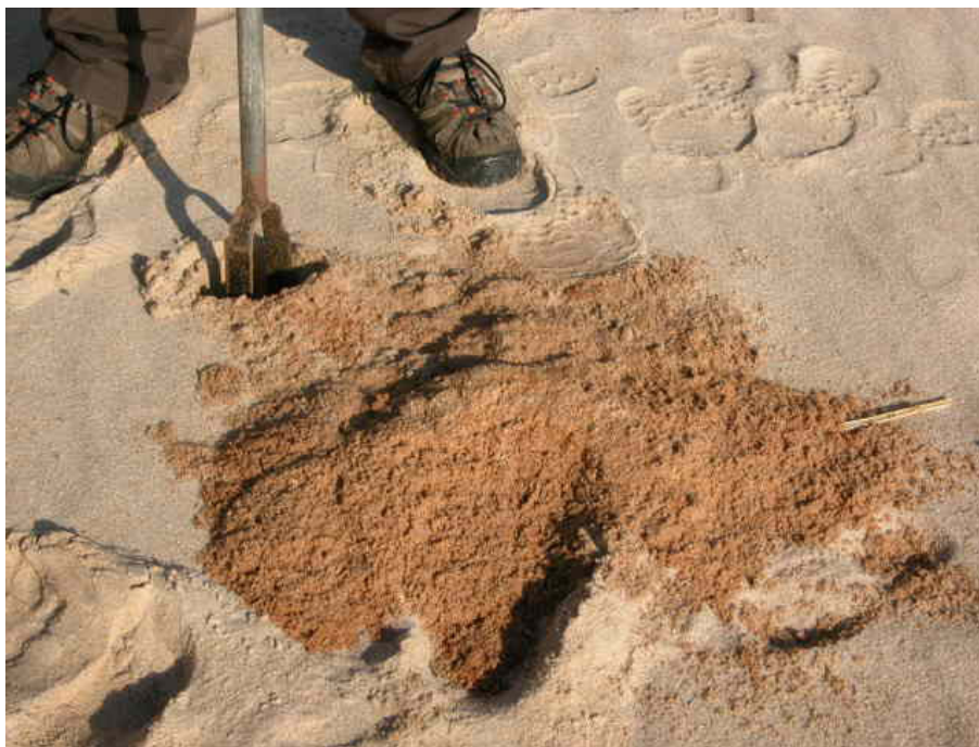
Figura 25 – Diferença de cor e tonalidade entre a areia lavada e a areia argilosa, recolhida com um trado (22/12/2014).
