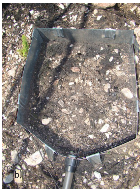
Figura 2 - Parcelas da área de estudo. (a) microparcela e tanque de recolha de água de escorrência; (b) pormenor da microparcela.
