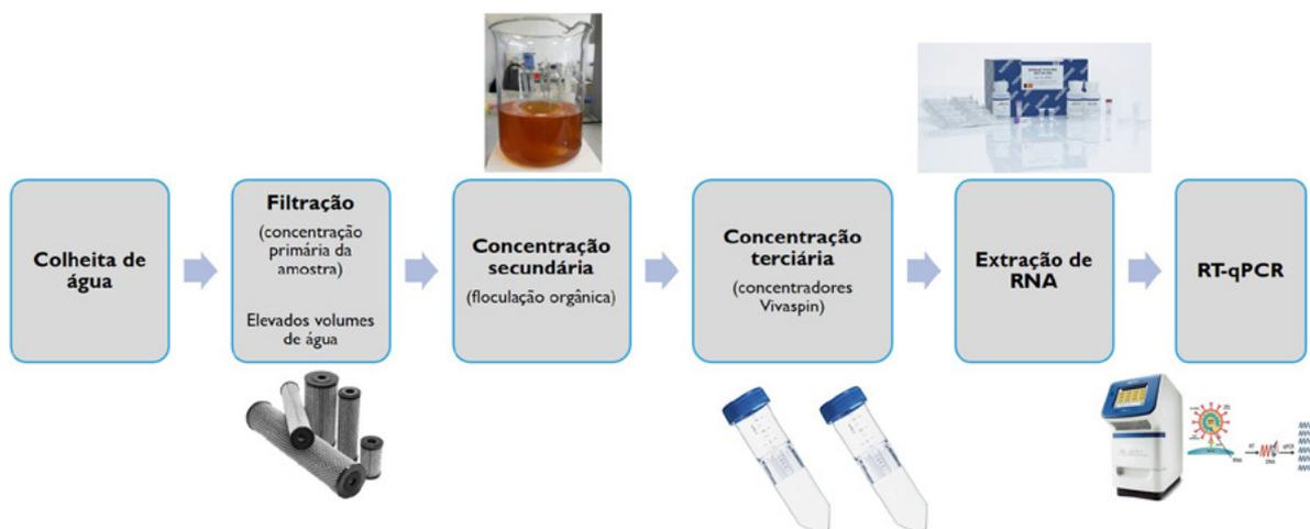
**Figura 2.** Representação esquemática do procedimento experimental para pesquisa do RNA viral em amostras de água natural e água para consumo.
