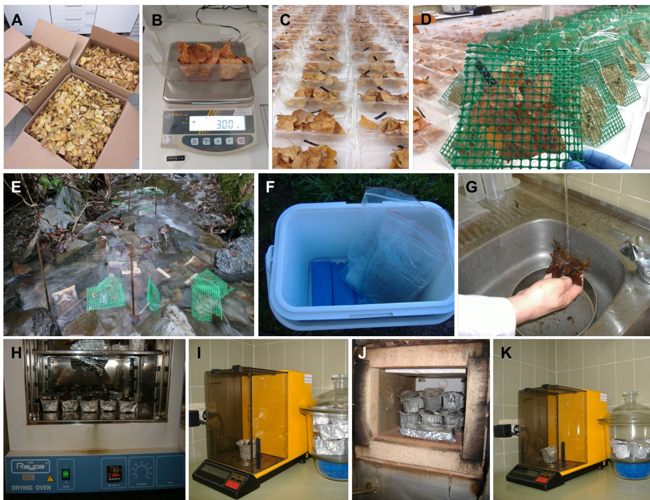
Figura 2. Metodologia para o estudo da decomposição de matéria vegetal com recurso a sacos de rede. Folhas senescentes previamente secas ao ar (folhada; A) são pesadas (B), etiquetadas (C) e colocadas em sacos de rede (D). Os sacos de rede são incubados nos ribeiros (E) para permitir a decomposição da matéria vegetal. Após algum tempo, os sacos de rede são recolhidos, colocados em sacos de plástico e transportados em mala térmica (F) para o laboratório. No laboratório, a matéria vegetal remanescente é lavada sobre um crivo com 0,5 mm de malha para reter pequenos fragmentos vegetais (G). A matéria vegetal é depois colocada em caixas de alumínio pré-pesadas, seca numa estufa (H) e pesada (I) para determinação da massa seca remanescente. A massa seca é queimada num forno (J) e as cinzas são pesadas (K). A massa seca livre de cinzas remanescente resulta da diferença entre a massa seca (I) e a massa das cinzas (K). ©Verónica Ferreira
