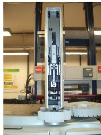
Cromatógrafo gasoso Trace GC acoplado a um espectrómetro de massa Trace DSO
