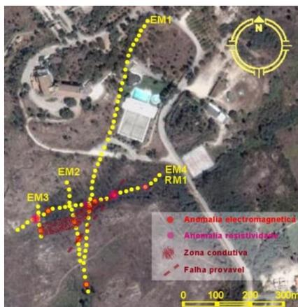
Fig.4. Alinhamentos definidos pelas anomalias assinaladas nos perfis de prospecção electromagnética e secção de resistividade eléctrica (adaptado de <http://earth.google.com>, consultada em Abril 2010)
