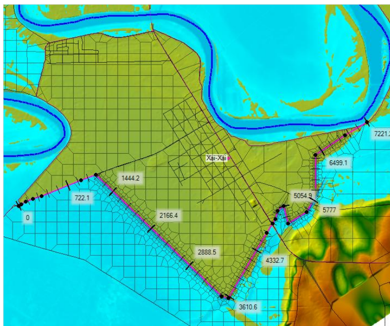
Fig. 1. Modelação de diques de protecção contra cheias em volta da Cidade de Xai-Xai
