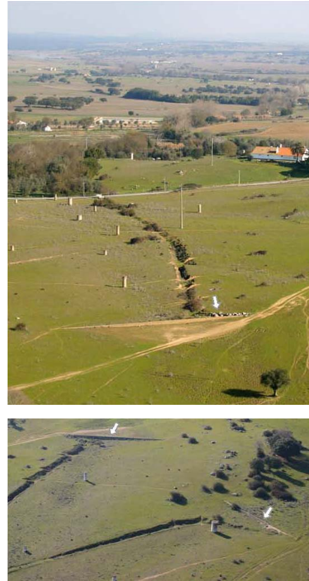
Fig. 40 – Pequenas represas para recarga de aquíferos na zona do Vale do Aluminio (assinaladas nas fotografias) e torres de captação (J. Mascarenhas, 2005).
