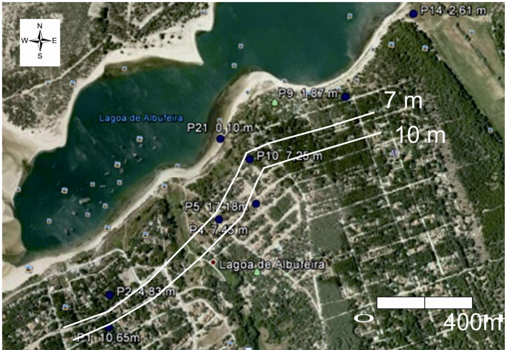
Figura 4 - Distribuição espacial dos níveis piezométricos dos poços em condições de barra aberta (C1). As linhas correspondem às piezolinhas dos 7 m e dos 10m (adaptado de Duarte, 2012).
