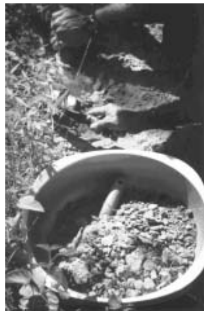
Figura 3 Procedimento de coleta de sedimento de fundo. A coleta foi realizada utilizando-se pás e bacia de plástico para evitar contaminação por metais.
