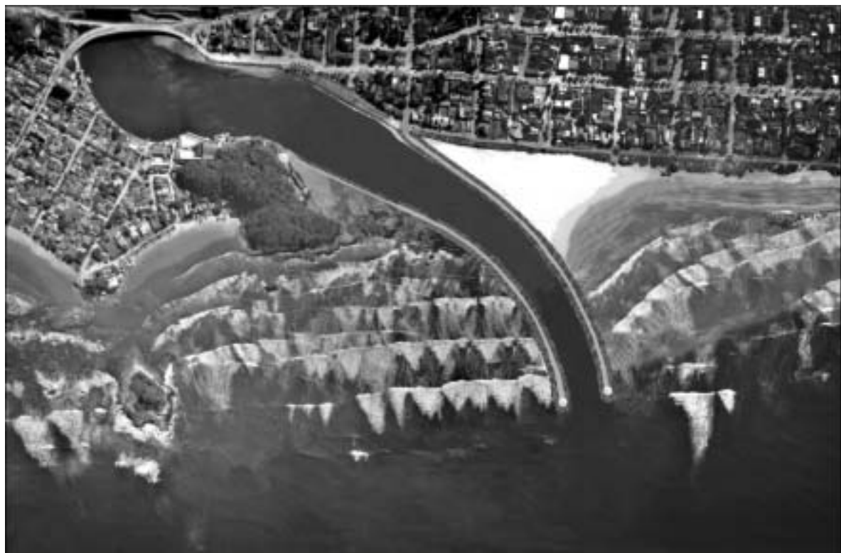
Figura 17: Impacto hidrossedimentológico com a implantação dos molhes
