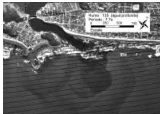
Figura 5: Frentes de ondas superpostas à foto aérea
