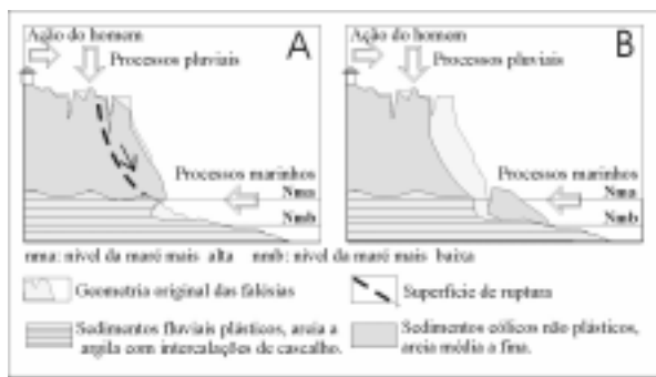
Figura 2 – Modelo esquemático da ação de processos erosivos sobre as falésias na margem SE da embocadura da laguna de Guaraiás (modificado de Amaral, 2001) .
