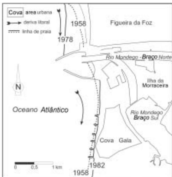
Figura 3 – Modificações da linha de costa na zona da foz do Mondego, na segunda metade do Séc. XX. Note-se a intensa acumulação a barlar e a erosão a sotamar, ameaçando a povoação de Cova-Gala.
