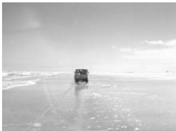
Fotografia 1. Levantamento da linha de praia com sistema de posicionamento global – GPS, usando como referência a linha de água associada ao espraiamento da onda.
