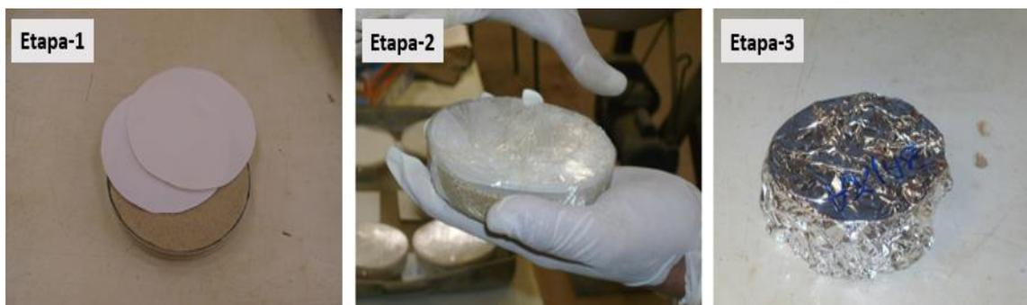
Figura 4. Etapas de preparação das amostras para a sucção mátrica.
