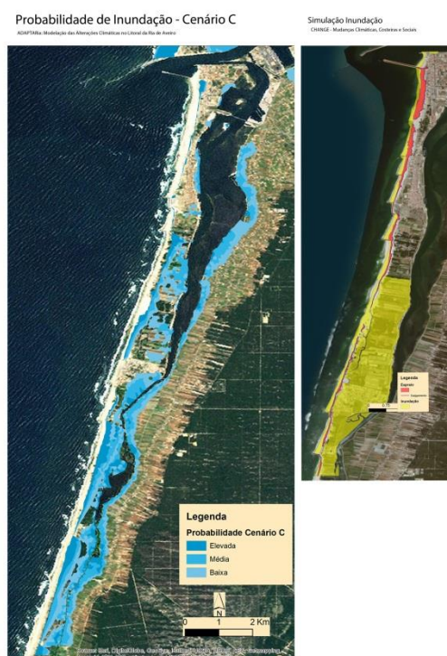
Figura 1 - (esquerda) Mapa da probabilidade de inundação no troço costeiro Barra-Areão no ano de 2100 em cenário de alterações climáticas com 0,62m de subida do nível médio do mar e sobrelevação meteorológica e cheia com período de retorno de 100 anos. Fonte: (Dias e Alves, 2013). (Direita) Mapa do risco de galgamento no troço Barra-Vagueira em 2100 em cenário de alterações climáticas B1 com 0,62 m de subida de nível médio do mar em 2100 e agitação meteorológica com sobrelevação meteorológica com período de retorno de 100 anos (forçamento intermédio). Fonte: (Vargas e Santos, 2013).
