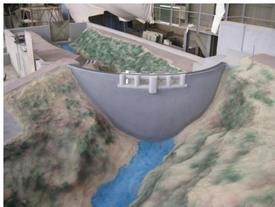
Figura 2. Modelo físico finalizado construído através do método tradicional
