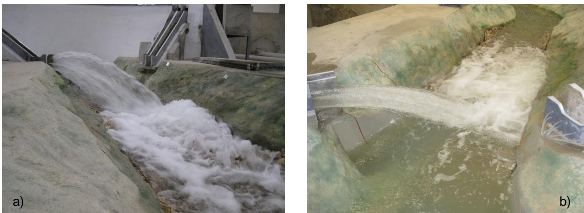
Figura 3. Formas de projeto. Ensaio com o caudal de projeto, 913 \text{ m}^3/\text{s} , no descarregador direito, a), e esquerdo, b).
