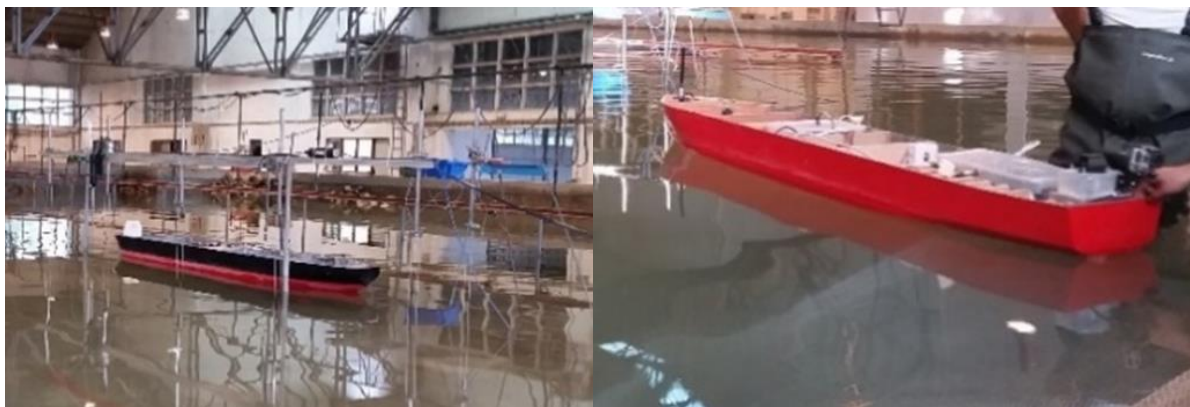
Figura 2. Esq.) Modelo do navio “Esso Osaka”, sondas resistivas e ADV's; Drt.) Modelo do navio “Aurora”
