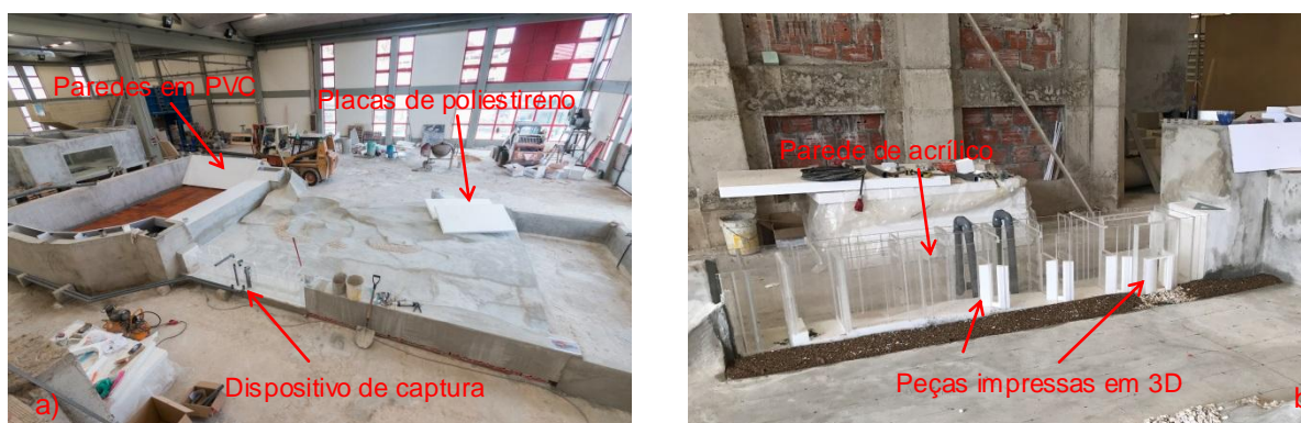
Figura 7. Modelo físico a ser construído utilizando novos processos de construção, a) vista geral, b) dispositivo fixo de captura de ictiofauna
