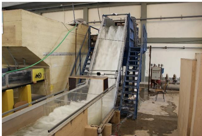
Figura 1. Instalação experimental existente no LNEC: vista do descarregador em degraus, com soleira do tipo PKW, e da bacia de dissipação de energia.
