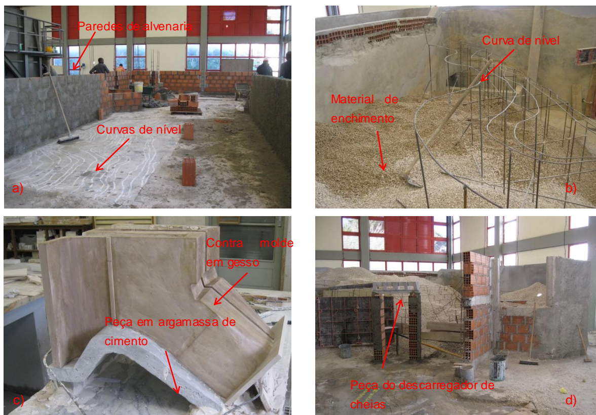
Figura 1. Processo tradicional de construção: a) limites do modelo e marcação das curvas de nível, b) reprodução das curvas de nível e enchimento, c) materialização de uma peça de um descarregador de cheias, d) implantação das peças do descarregador de cheias
