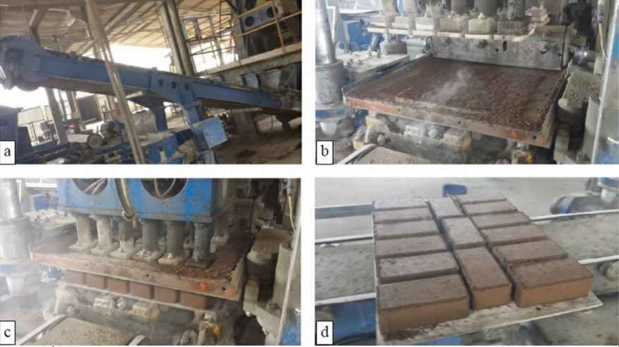
Figura 8 - Sequência da produção dos Pavers. Em (a) misturador dos insumos com resíduo de ETA (b)carregamento das fôrmas, (c) carregamento das fôrmas, (c) prensagem dos pavers, (d) pavers prontos.
