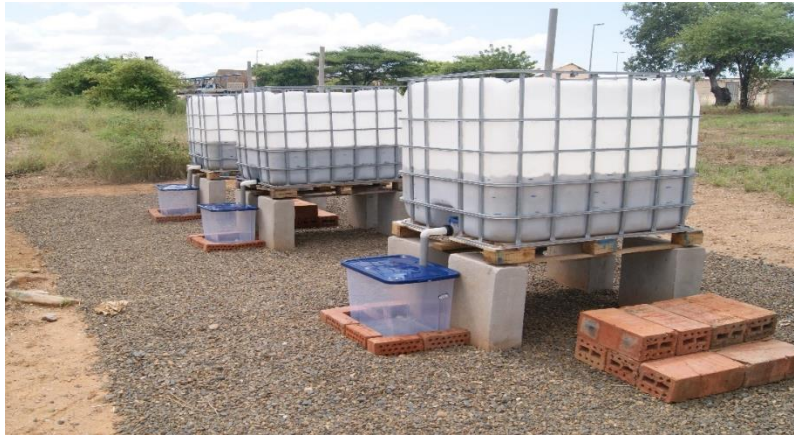
Figura 3. Instalação-piloto de tratamento de lamas na cidade de Tete, Moçambique
