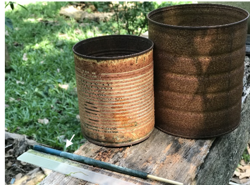
Figura 2. Pluviômetros de diâmetros 10 e 12,8 cm e a medição de uma chuva de 39 mm. A seta mostra o nível da água no marcador.
