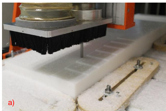
Figura 4. Maquinação CNC: a) máquina de corte CNC em operação, b) peça maquinada
