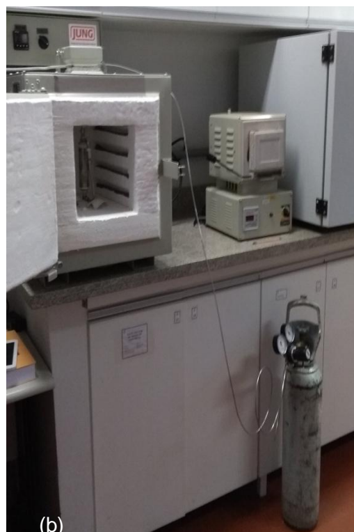
Figura 1. Reator de aço inox desmontado (a) e sistema de ativação com fluxo de gás ligado ao reator posicionado no forno mufla (b).
