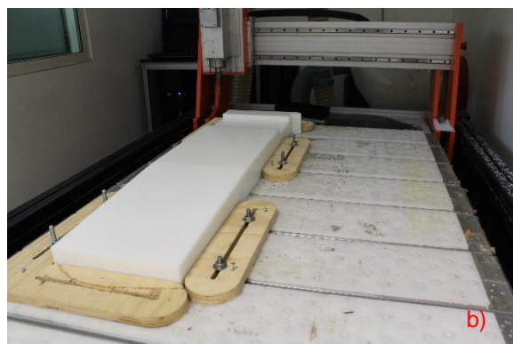
Figura 4. Maquinação CNC: a) máquina de corte CNC em operação, b) peça maquinada
