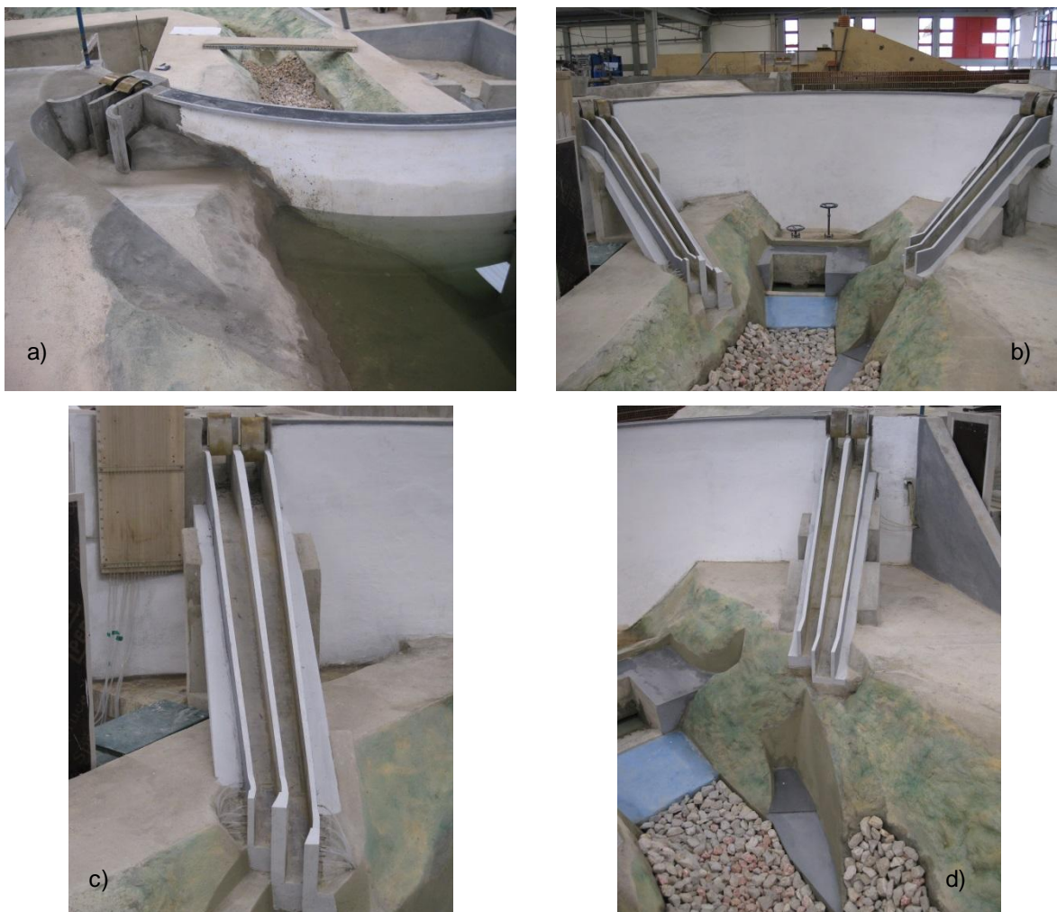
Figura 2. Modelo físico: a) vista de montante; b) vista de jusante; c) descarregador direito, vista de jusante; d) descarregador esquerdo, vista de jusante
