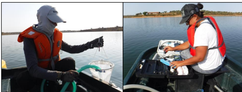
Figura 1 – Recolha de amostra com recurso a garrafa de Van Dorn (esquerda) e recolha de amostra para posteriormente ser filtrada para análise por PCR (direita).
