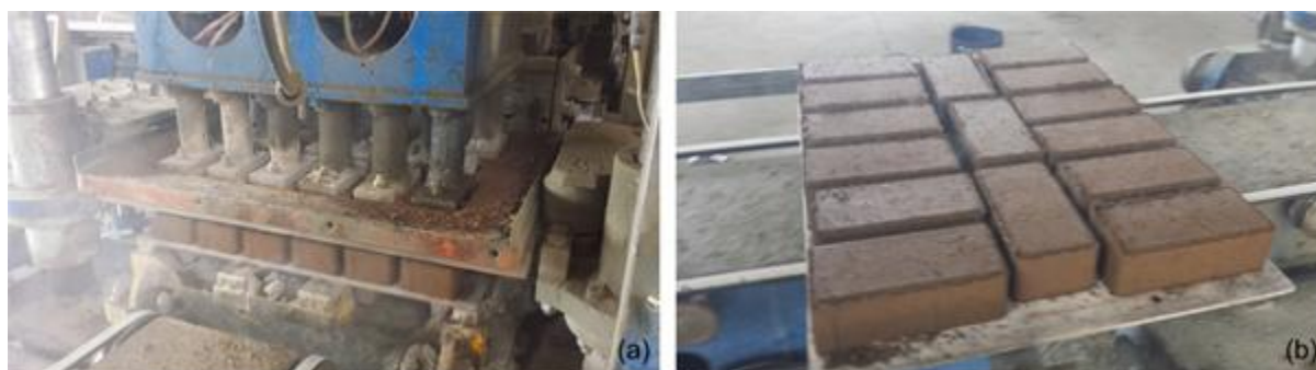
Figura 1. Produção do piso de concreto. (a) Prensagem das formas carregadas; (b) Peças do piso prensados.
