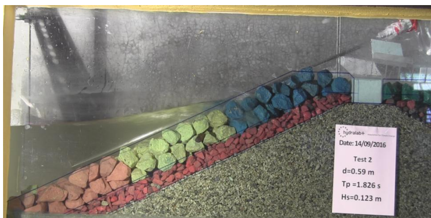
Figura 4. Teste 2: caso em que não foi identificado galgamento pela sonda de medição do espraiamento.
