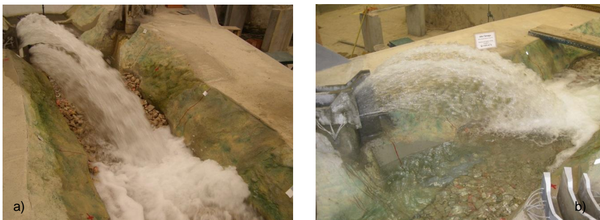
Figura 4. Formas propostas. Ensaio com o caudal de projeto, 913 \text{ m}^3/\text{s} , no descarregador direito, a), e esquerdo, b).
