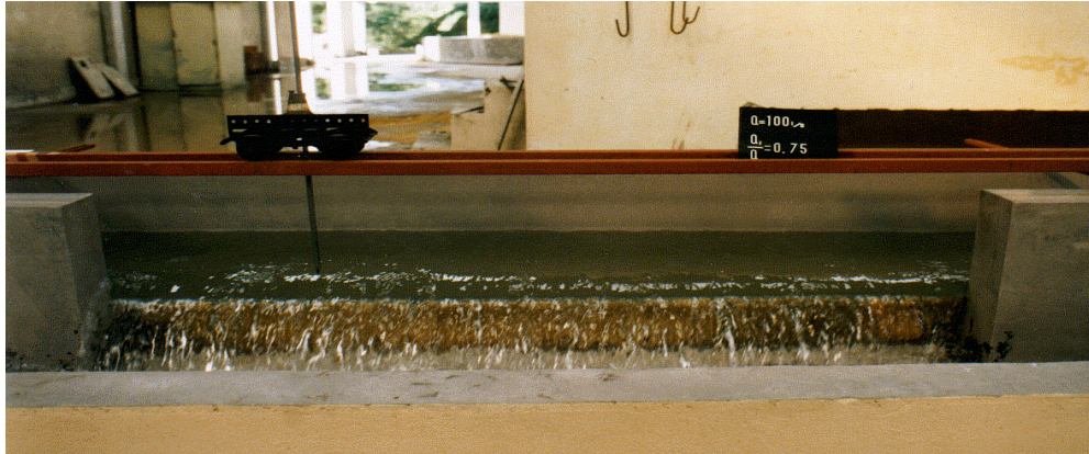
Figura 6 - Funcionamento do descarregador lateral. Q = 100 l/s. Q_L/Q = 0,75 . L=2,00 m.
