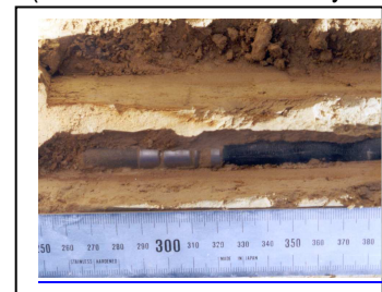
Figura 3. Sonda de succión y temperatura "V" durante pruebas de penetración.
