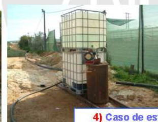
4) Caso de estudo Areal Gordo Ensaios de injeção em furos de diâmetro intermédio
