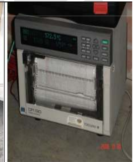
Registador de Temperatura ligado a termopar tipo K
