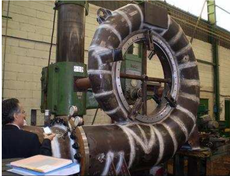
Figura 8 – Ensaio de pressão da câmara espiral da turbina
