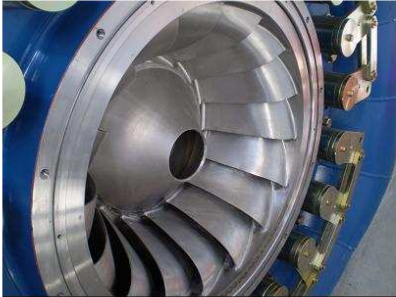
Figura 4 – Roda da turbina (690mm de diâmetro)
