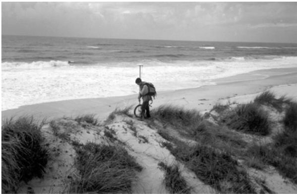
Figura 3. Sistema DGPS uni-antena transportado manualmente pelo operador. O sistema é composto por uma antena GPS montada num bastão na base do qual é adaptada uma roda. A antena é conectada ao receptor GPS que é transportado pelo observador. *in: Baptista et al. (no prelo)*.
