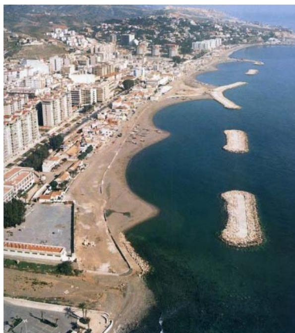
Figura 3 – Exemplo de quebra-mares destacados na praia de O Palo (Málaga - Espanha).
