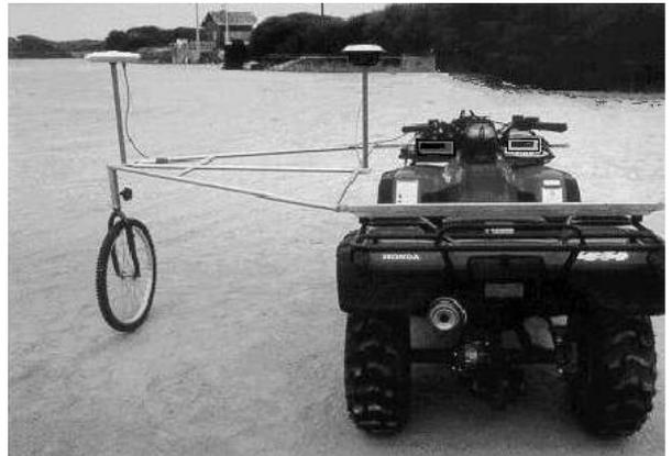
Figura 1. Sistema DGPS multi-antena adaptado a veículo moto-quadro. O sistema é composto por duas antenas GPS cinemáticas, as quais são instaladas num braço articulado fixo ao veículo. *in: Baptista et al. (no prelo).*
