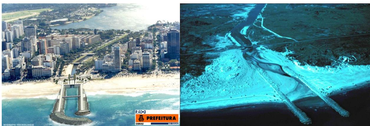
Figura 6 – Exemplos de aplicação de quebra-mares para estabilização de embocaduras: a) projecto para a Lagoa Rodrigo de Freitas, Brasil (cortesia da Fundação Rio Águas); b) Fish Pass, E.U.A. (Davies e Zarillo, 2003). Examples of the use of breakwaters to stabilize tidal inlets: a) Project for the Rodrigo de Freitas Lagoon, Brazil; b) Fish Pass, U.S.A. (Davies and Zarillo, 2003).
