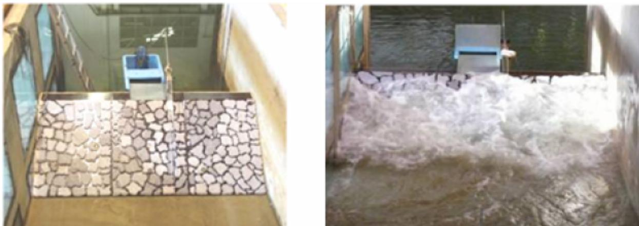
Figura 8 Modelo da estrutura e aspecto do galgamento.
