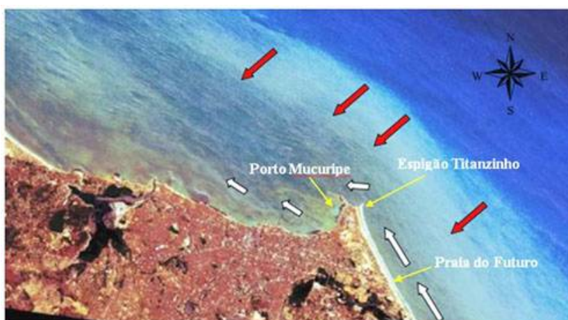
Figura 2. Mapa sobre imagem Landsat 7 ETM+ da Região Metropolitana de Fortaleza ressaltando a deriva litorânea dos sedimentos (segundo Bensi, 2006).
