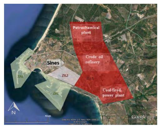
Figure 3 - Complex of Sines - Implementation of port and industrial areas (source: Google Earth). Figura 3 - Complexo de Sines - Implantação das áreas portuária e industrial (fonte: Google Earth).
