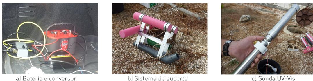
Figura 3 – Sistema de suporte desenvolvido para a sonda UV-Vis submersível.
