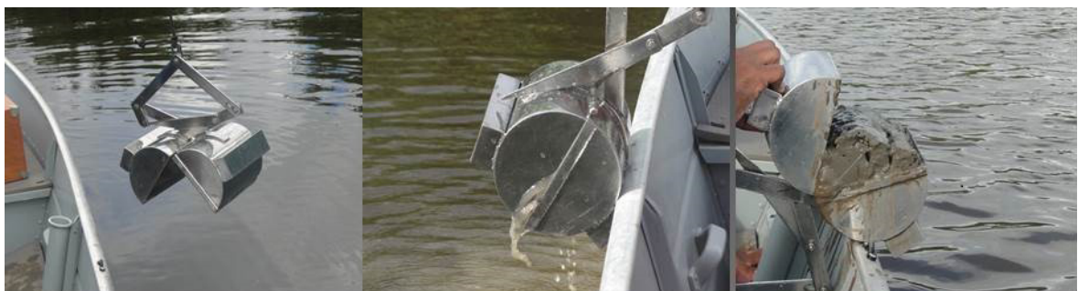
Figura 3 - Procedimento de coleta dos sedimentos de fundo.
