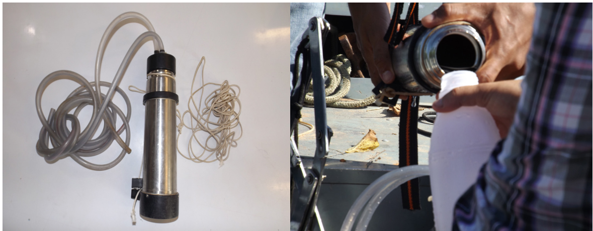
Figura 2 - Garrafa de Van Dorn, usada para coletar água.
