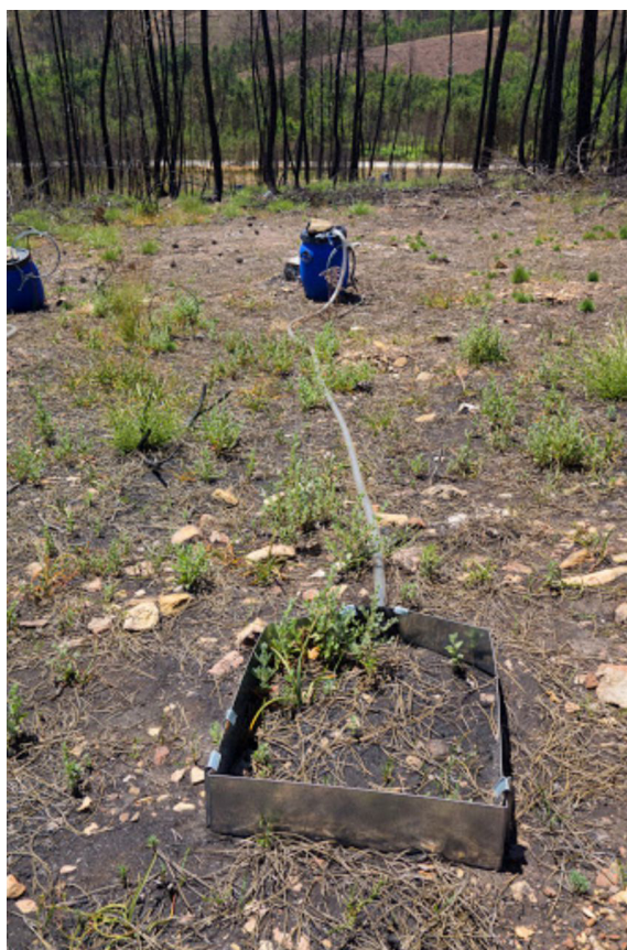
Figura 2 – Microparcela conectada a tanque de armazenamento (zona "Unifogo").
