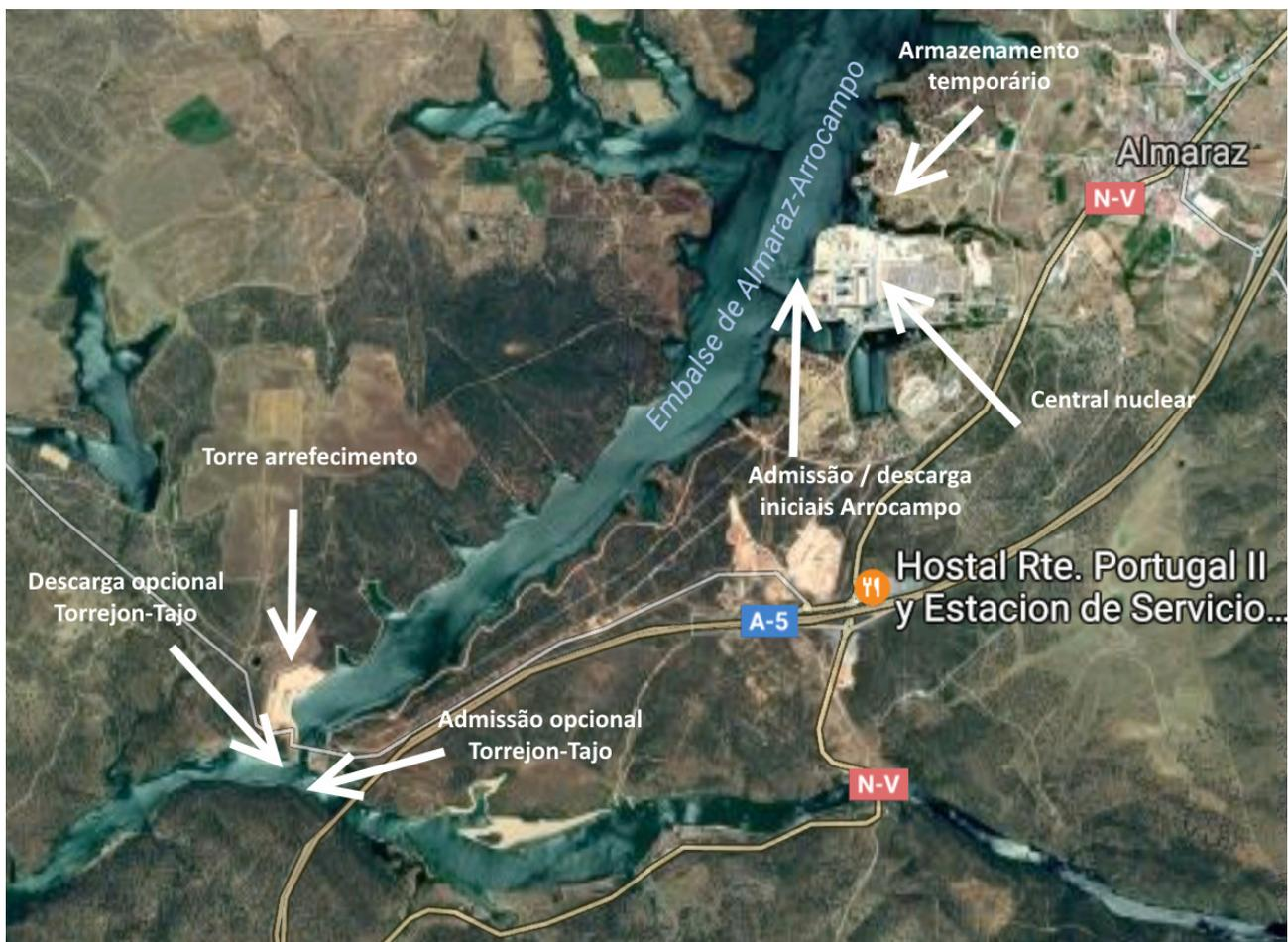
**Figura 1.** Utilização de água para arrefecimento (circuito terciário) pela central nuclear de Almaraz.
