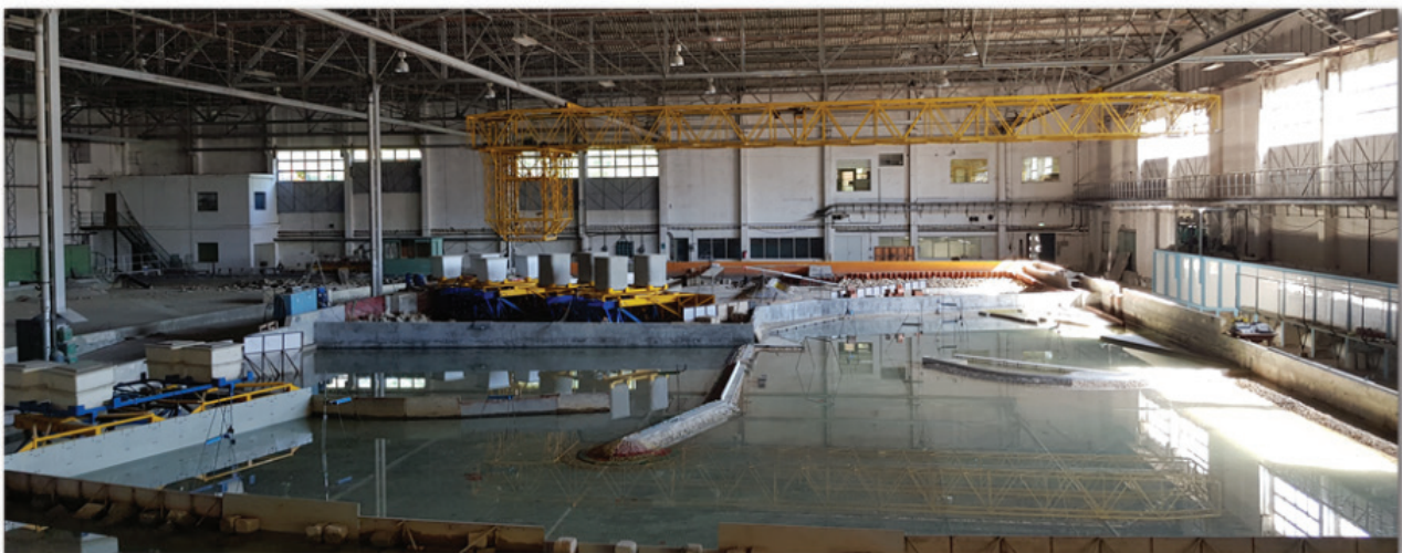
Figura 2. Vista do modelo físico de agitação do Porto de Leixões com prolongamento do molhe norte.
