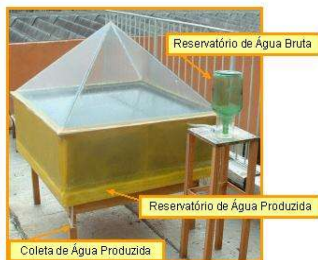
Figura 1 – Foto do equipamento de tratamento de água.
