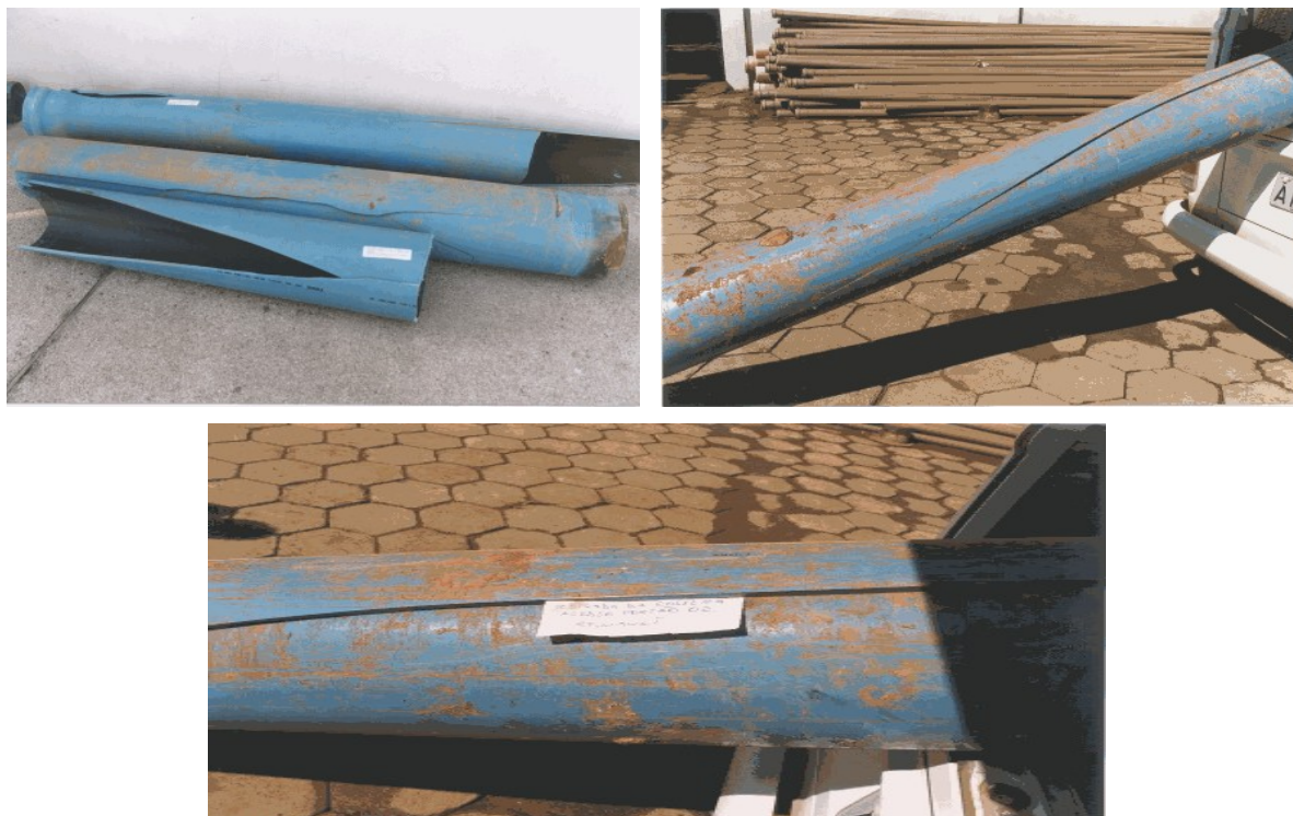
Figura 1 : Ruptura "tipo frágil" em tubos de PVC DEFOFO rígido
