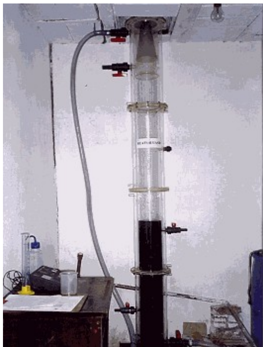
Figura 1: Reator UASB utilizado na pesquisa (203,6 cm; \phi 14,3 cm; v = 32,67 L).
