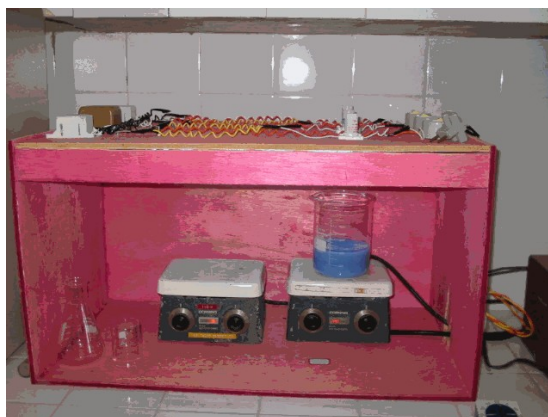
Figura 1 – Reator fotocatalítico tipo tanque e câmara de radiação UV
