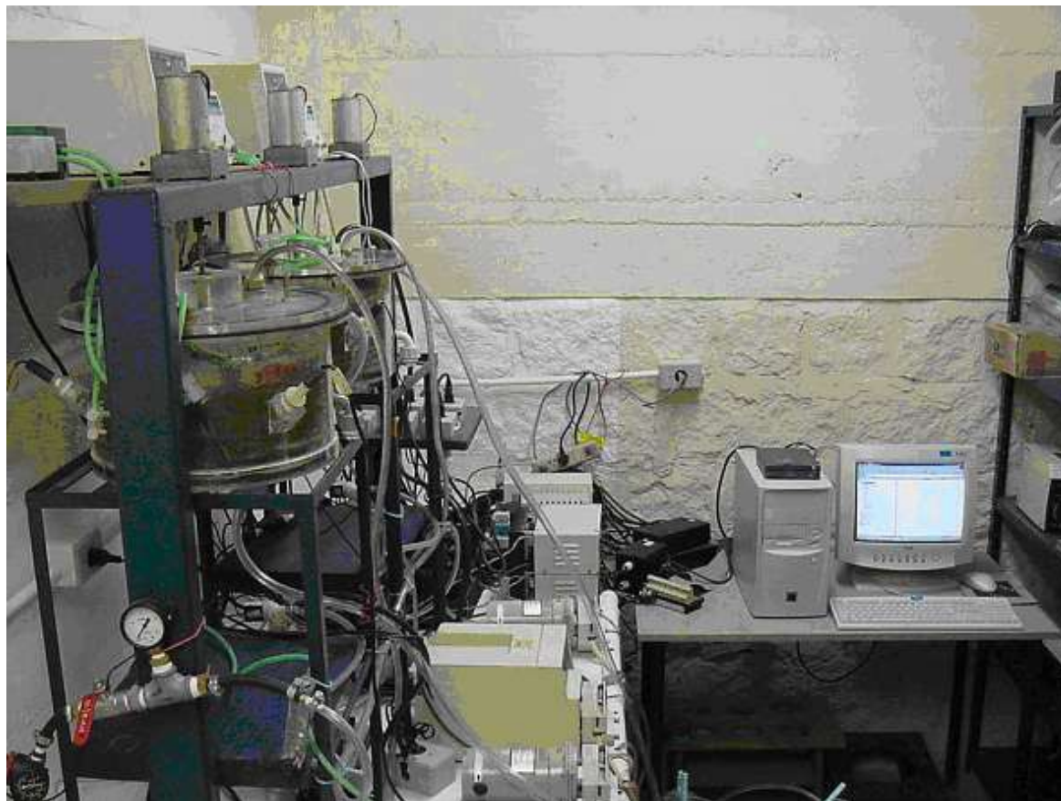
Figura 1 – Experimento com os dois RSB instrumentalizados, em escala de bancada.
