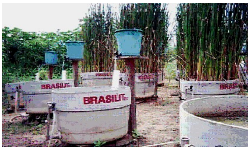
Figura 1: Detalhe da alimentação do sistema experimental de terras úmidas construídas.
