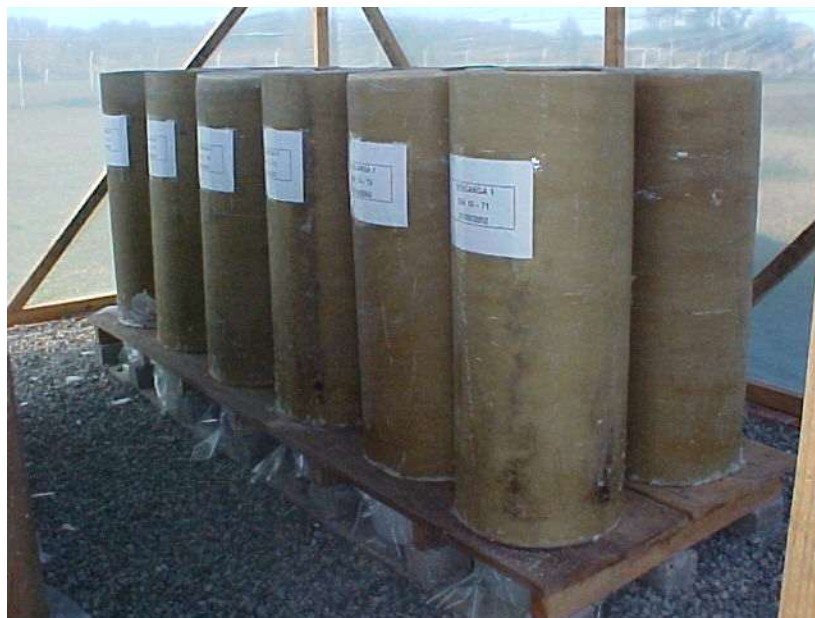
Figura 02 – Vista geral do leitos de secagem em bancada construídos em fibra de vidro.
