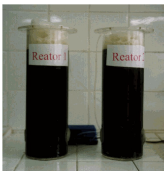
Figura 2- Aparato experimental para o teste de biodegradabilidade aeróbio.
