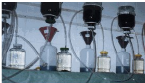
Figura 1- Montagem do aparato experimental do teste de biodegradabilidade anaeróbio
