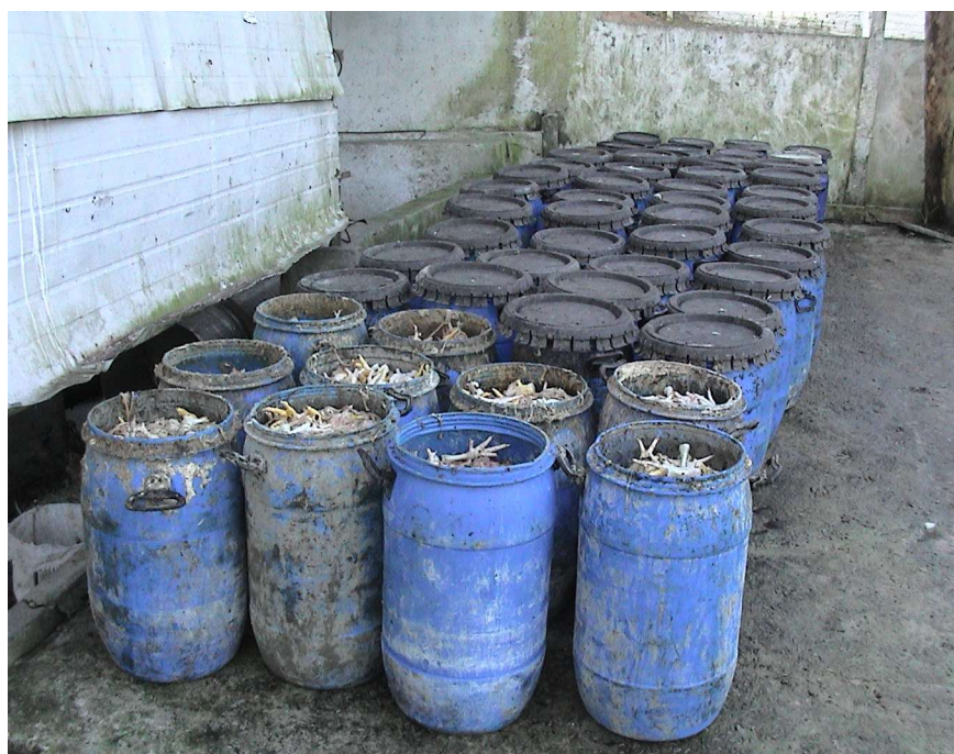
FIGURA 04: Armazenamento dos resíduos sólidos orgânicos separados na peneira rotativa da ETEI da AGROINDÚSTRIA S/A.
