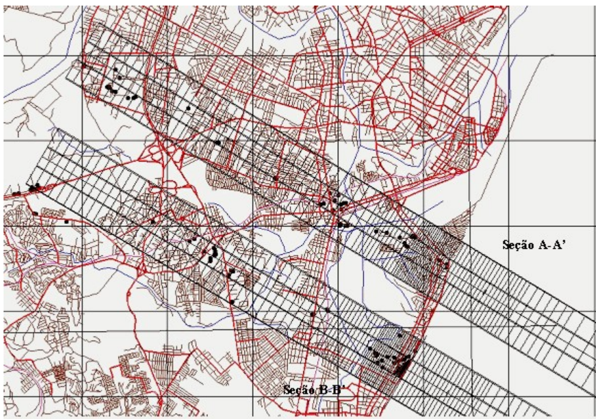
Figura 8: os pontos pretos são os poços cadastrados cujos dados de vazão foram utilizados neste estudo.
