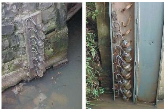
Figura 3: Amostradores de nível ascendente instalados na Bacia Hidrográfica Alto da Colina.
